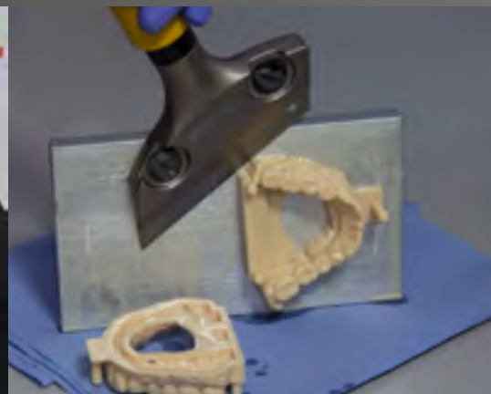
16 Die Modelle werden mithilfe eines Universalschabers vorsichtig von der Bauplatteform gelöst.
