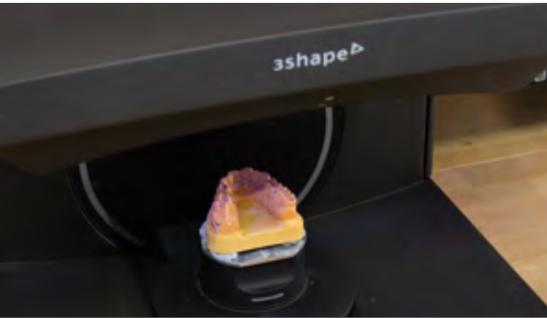
03 Eine andere Möglichkeit: Scan des Modells im Desktop-Scanner E3 von 3Shape. Die damit generierten Daten können in der CAD-Software weiterverarbeitet werden.
