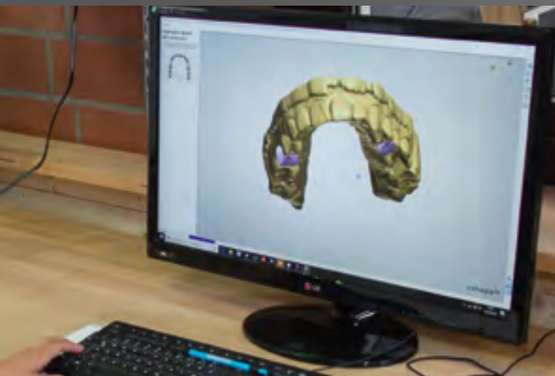
05 In der Software erfolgt die Konstruktion des virtuellen Modells, das auf Basis der STL-Daten vom Intraoral-Scan (oder Desktopscans) generiert wurde.
