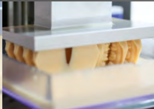
12 & 13 Modelldruck auf dem envisionTec-Drucker Vida. Die darin verbaute industrielle UV LED-Lichtquelle belichtet dabei das Harz im sogenannten Maskenbelichtungsverfahren – und zwar nicht punktuell, sondern Schicht für Schicht.
