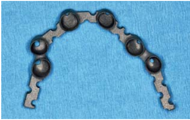
Abbildung 2.5 Tertiärgerüst, hergestellt durch selektives Laserschmelzen
