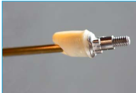
Studie zum Verkleben von Zirkoniumdioxidabutments
